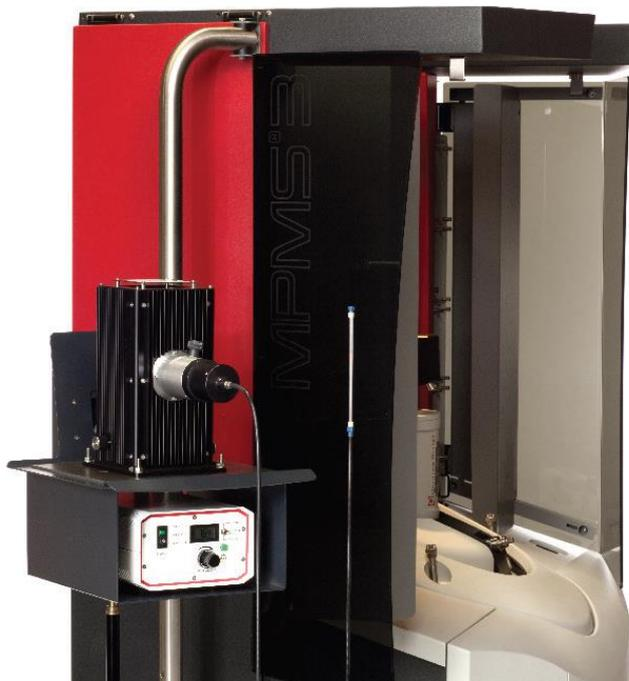
MPMS 3 с ксеноновым источником света (MLS) на 150 Вт и держателем для образца FOSH
