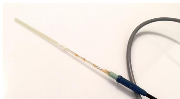
*Стержень для образца MIUP и держатель для образца, подключённые к блоку адаптера M3R*
