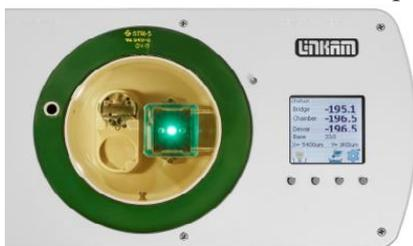
**Встроенная конденсерная оптика** - позволяет использовать технику светопольного преломлённого света, которая идеально подходит для предварительного осмотра сетки и местоположения образца.
