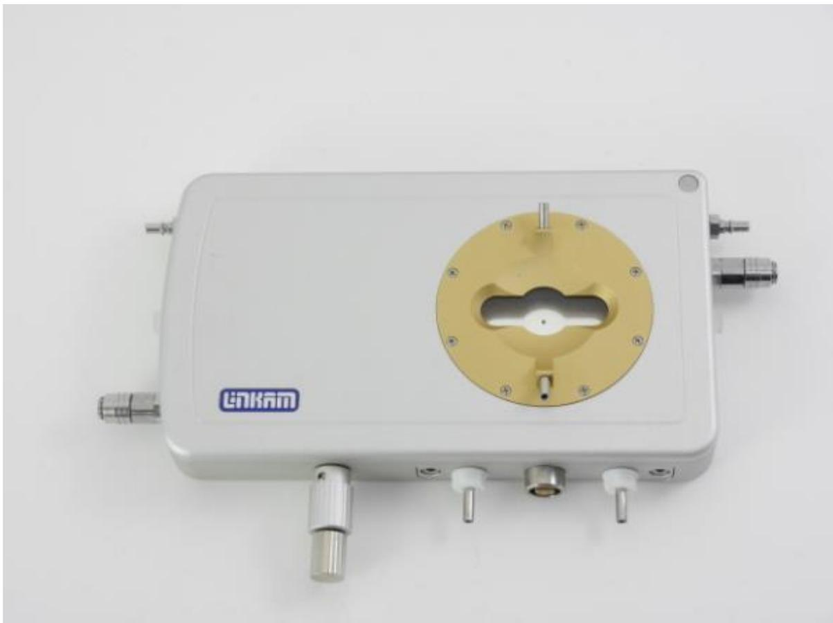
Приставка САР500 сконструирована специально для того, чтобы нагревать и охлаждать капилляры в диапазоне температур от -196 до 500 °С. Система позволяет контролировать температуру части кварцевого капилляра высокого давления длиной до 50 мм. В комплект приставки входит ромбовидный вкладыш, поворачивая который, можно быстро переключаться между двумя капиллярами разных размеров.
